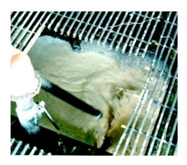
En foto 6 y 7 se observa la espuma con densidad de 0.48 g/cc formada por golpeo, esto se logra con el flujo de la Bomba Discflo, las bombas actualmente
