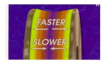
"Cuando los discos rotan, una energía friccional es transferida a las sucesivas capas de moléculas del fluido. Note que relativo a las superficies de los discos, la capa limite esta quieta pero relativo a un observador externo, la capa límite esta moviéndose rápidamente"
