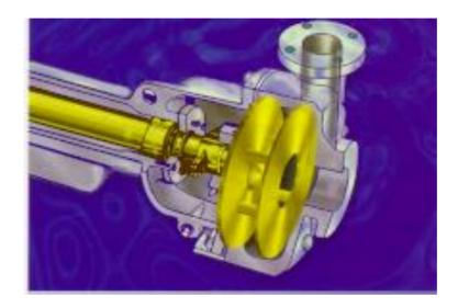
"Como los discos rotan, la masa entera de fluido dentro de la bomba rota, creando una poderosa fuerza centrífuga friccional la cual impulsa al fluido fuera de la bomba en un suave flujo laminar. Nosotros podemos decir es jalado preferiblemente que empujado a través de la bomba"
